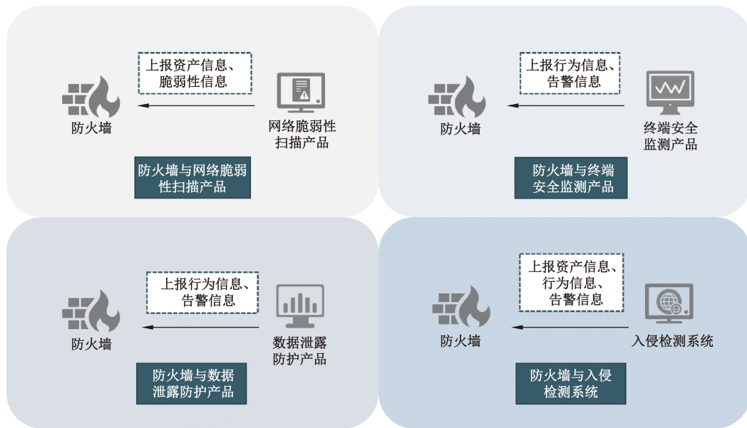
图 A.3 防火墙与相关网络安全产品互联互通示意图
